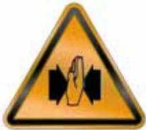
Zwischen der Abstützvorrichtung und dem Werkstück besteht Quetschgefahr.
