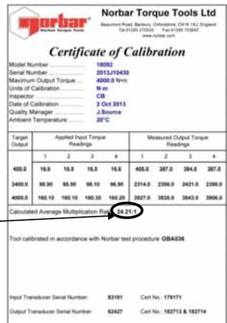
**ABBILDUNG 7** – Bei der Compact Series mitgeliefertes Kalibrierungszertifikat (für anwendbare Modelle siehe oben).
